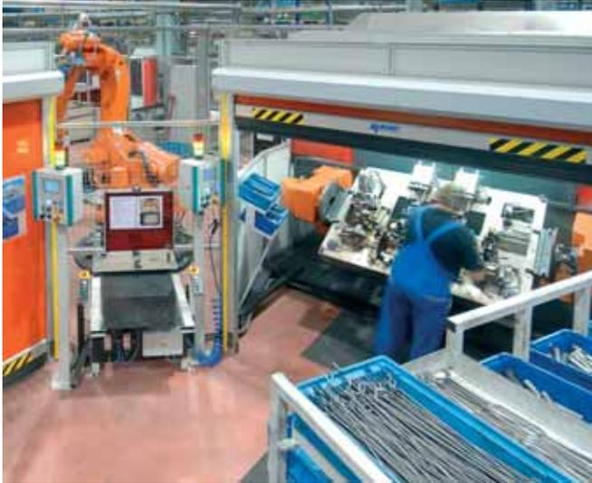
Roboterzelle für Metallstrukturen für Hintersitze.
