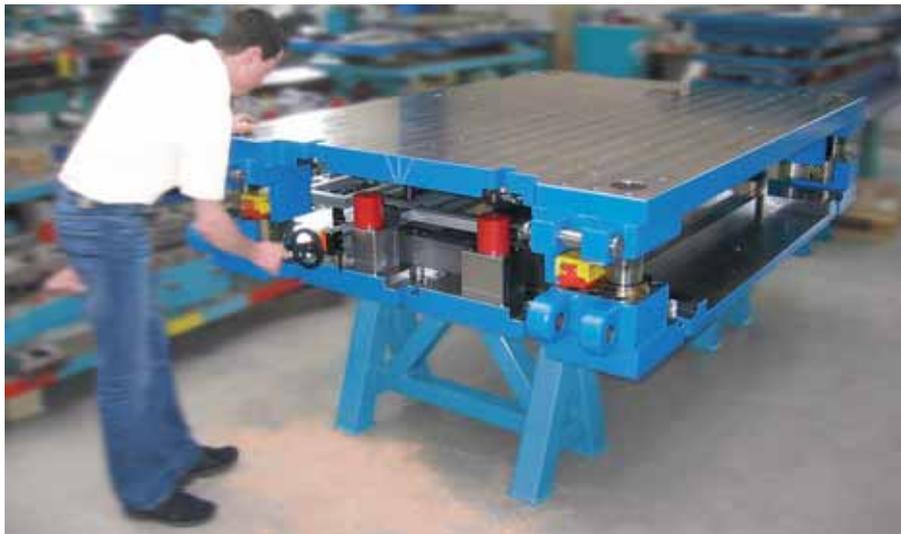
**Platinenschneidwerkzeug von Anchor Lamina.**
