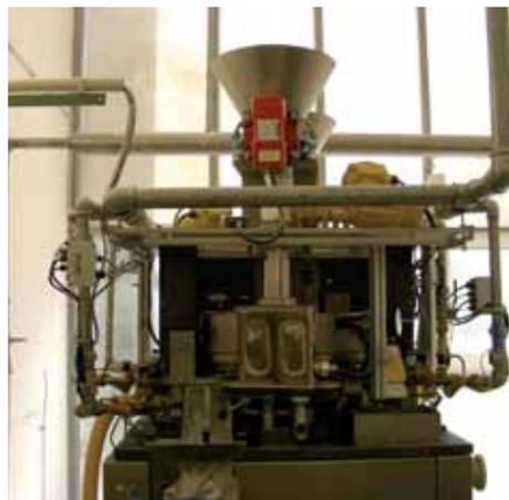
Rundlaufpresse für pyrotechnische Gas-satztabletten.
