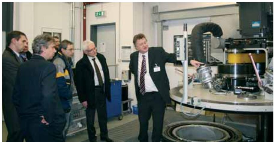
Zur modernen technischen Ausstattung des ILK gehört ein Hochgeschwindigkeits-Rotorprüfstand für Zyklen- und Berstversuche.
