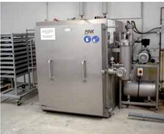
**Vakuumtrockenschrank für Chemikalien.**
