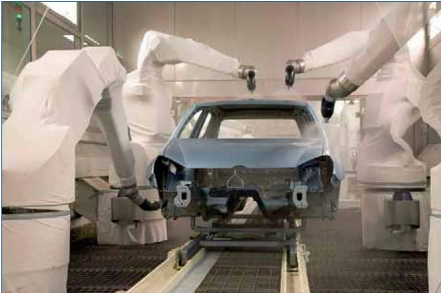
Lackierprozess in der VW-Fahrzeugfertigung Zwickau.
