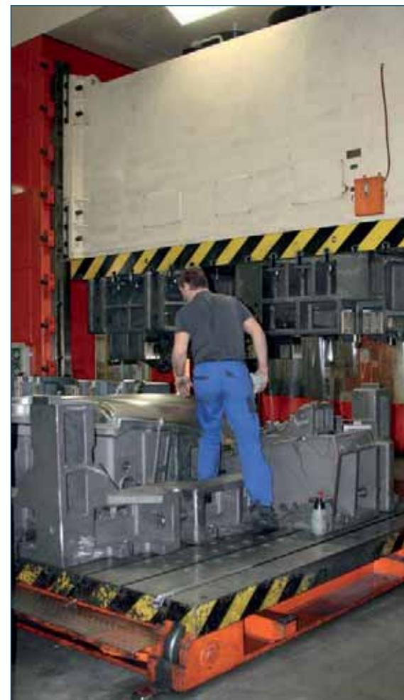
**Try-out-Prozess zur Erprobung eines Serienwerkzeugsatzes.**
