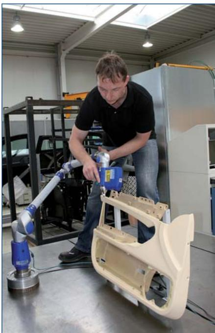
**Vermessung eines Bauteils mit mobiler Lasertechnik.**
