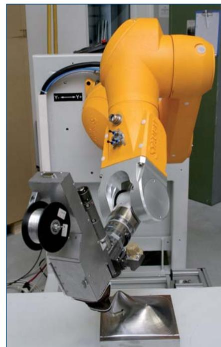
**Auftragschweißeinheit von LASERVORM mit integriertem Drahtförderer.**
