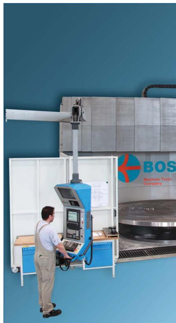
Die neue CNC-Karusselldrehmaschine ermöglicht die Bearbeitung von Großdrehteilen bis 4000 Millimeter Durchmesser und einer Drehhöhe bis 1800 Millimeter.
