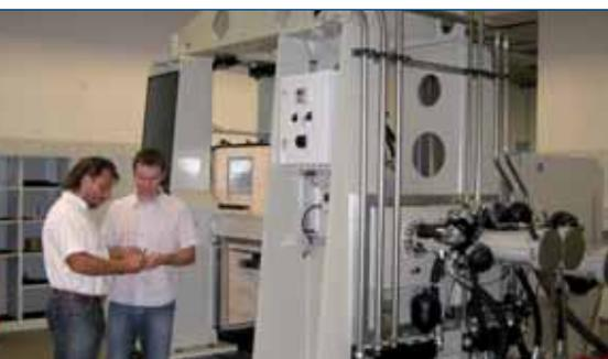
Zum modernen Prüffeld gehört eine neue Hydropulsanlage.
