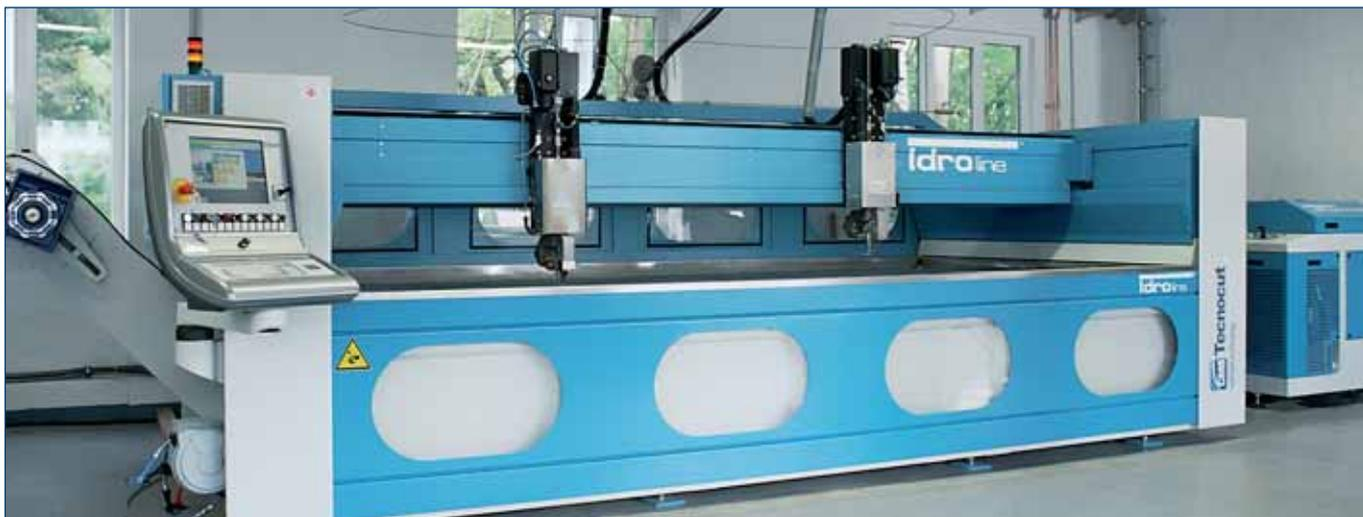
Die neue Wasserstrahlschneidanlage bei montara gestattet das dreidimensionale Schneiden von Konturen.
