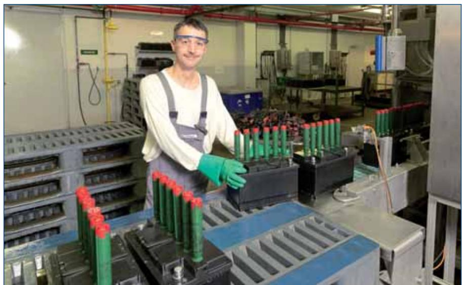
Nach der Formation werden die Batterien mit Schwefelsäure befüllt und mit Strom geladen. Die Schwefelsäure reagiert mit dem Blei-Oxid der Paste.
