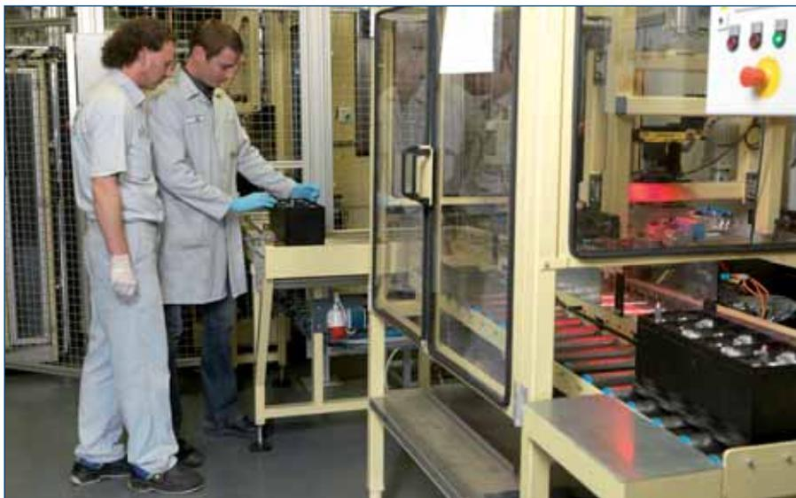
**Kontrolle der korrekten Widerstandsschweißung und der Polausrichtung in der AGM-Batteriefertigung bei Johnson Controls in Zwickau.**
