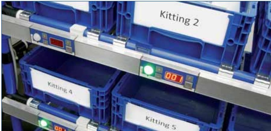
Dieses innovative System kombiniert Prozesssicherheit mit erhöhter Kommissionierleistung.
