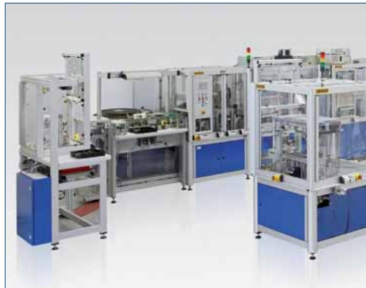
**Vollautomatische Fertigungsanlage für mechatronische MID-Baugruppen.**
