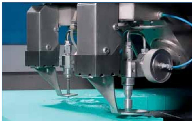
Gleichzeitiges Schneiden mit zwei Schneidköpfen.
