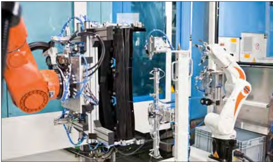
Automatisierung dominiert in der Produktion bei WEIDMANN in Treuen, hier die in den Spritzgießmodus integrierte Clipmontage.
