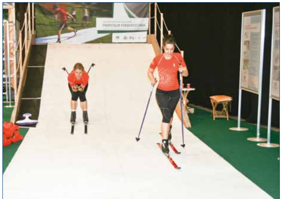
Diese mobile Skipiste besteht aus einem dreischichtigen, luftdurchlässigen Textilverbund. Das Material kann auch in der Fördertechnik Anwendung finden.
