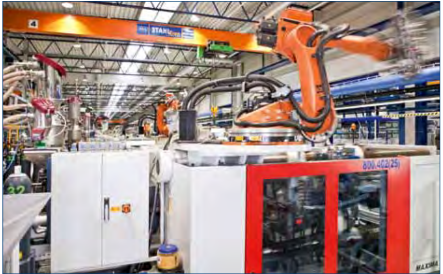
Vollautomatische Teileentnahme mit einem 6-Achs-Roboter.
