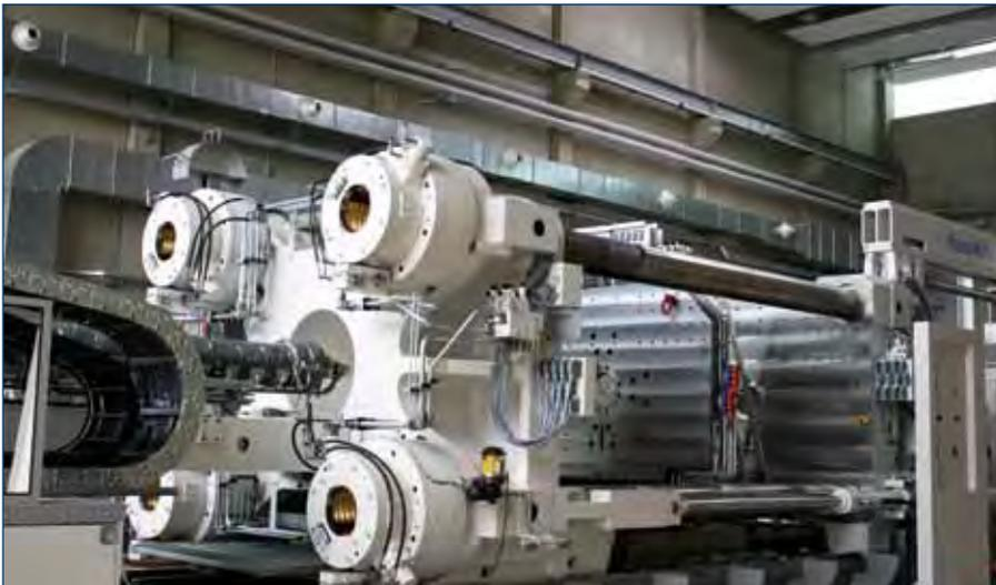
Im Technologiezentrum des Leichtbau-Bundesexzellenzclusters MERGE an der TU Chemnitz erfolgen gegenwärtig Aufbau und Inbetriebnahme der MERGE-Maschine. Darauf werden Verfahrenskombinationen zur effizienten Verarbeitung von kunststoff-, metall- und textilbasierten Werkstoffen erprobt.
