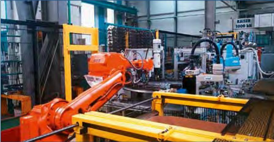
In dieser automatischen Montagezelle entstehen Sitzseitenteile, die in ein neues Modell von Volvo eingebaut werden. Mit der Erweiterung der Baugruppenmontage inklusive moderner Füge-technologien erhöht die WESTFALIA Presstechnik in Crimmitschau ihre Wertschöpfung.
