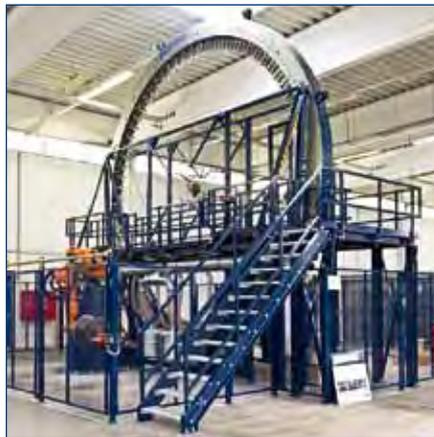
ThyssenKrupp Carbon Components und Maxion Wheels entwickeln und vermarkten gemeinsam Leichtbau-Felgen aus Aluminium und CFK. In dieser Carbon-Flechtanlage werden die Materialien miteinander verflochten.
