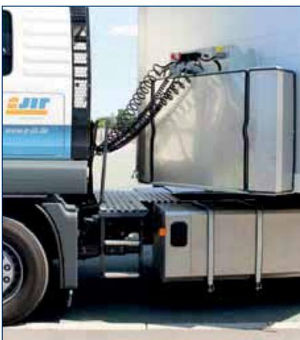
Dort, wo sich bei Diesel-Lkw die Kraftstoffbehälter befinden, haben die eJIT-Prototypen Batterien mit Ladevorrichtung.
