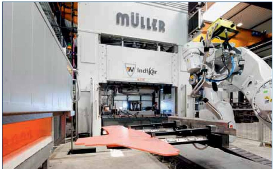
Blick in das neue Technologiezentrum Presshärten bei IndiKar. Eine auf bis zu 1000 Grad Celsius erwärmte und bis zu 150 Kilogramm schwere Platine wird von einem Roboter aus dem Glühofen genommen und in die Presse transportiert.
