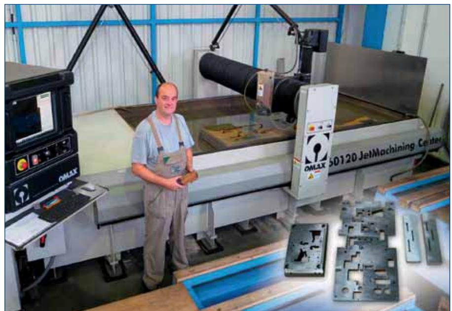
Moderne Wasserstrahl-Schneidtechnik bei WKFS. Damit wird u. a. das nacharbeitungsfreie Einbringen von Konturen in Werkzeugplatten möglich.
