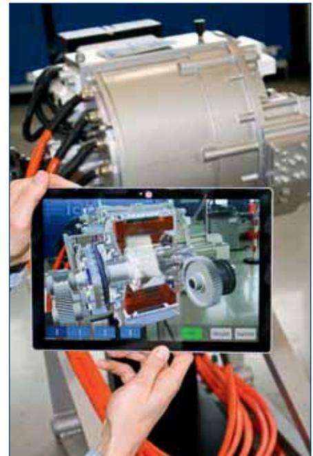
Virtuell Reality (VR) und Augmented Reality (AR) nutzen IAV-Ingenieure, um Entwicklungen noch vor dem Prototypenstadium zu testen bzw. zu simulieren. Hier der Blick in ein Getriebe mittels AR.
