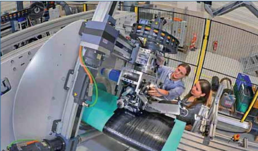
Die wissenschaftlichen Mitarbeiter am Bundesexzellenzcluster MERGE und der TU Chemnitz Rainer Wallasch und Dr. Agnieszka Kalinowska bei der Erprobung der weltweit einzigartigen Pilotanlage zur Fertigung komplexer Strukturbauteile, wie belastungsgerechte Profile für den Fahrzeugbau.
