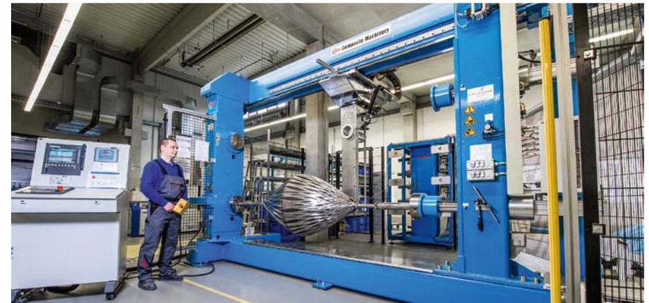
Mit dem patentierten „Filament Winding Forming“ wickelt East-4D beispielsweise Triebwerkseinlaufkegel für Flugzeuge. Auch die Autoindustrie nutzt die Kompetenz des Dresdner Unternehmens für CFK-Hightech-Produkte.
