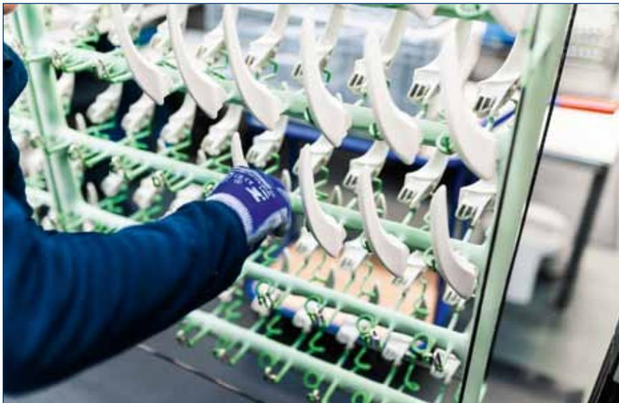
Foto S. 24: Interieurteile werden bei SAXONIA Galvanik zum Galvanisieren vorbereitet.
