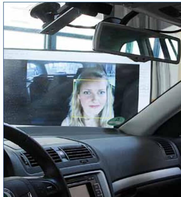
Multisensorielle Fahrzeuginnenraumüberwachung. Damit wird u. a. das Befinden des Fahrers erfasst. Mit diesen Informationen lassen sich z. B. die Kontrollübergabe und der Fahrstil beim automatisierten Fahren optimieren.
