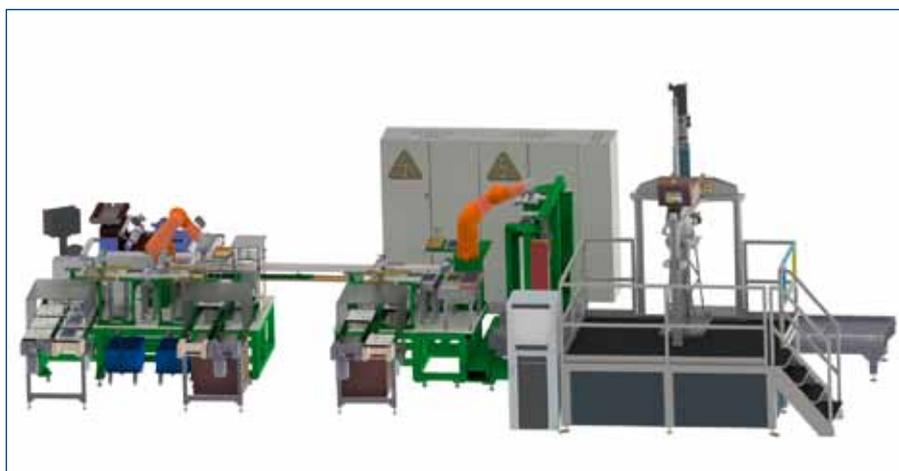
Layout einer Anlage zur automatischen Fertigung und Montage von Brennstoffzellen von USK. Die Technologie entsteht im Projekt Fit-4-AMandA, einem Vorhaben im Rahmen des EU-Innovations- und Forschungsprogramms Horizon 2020.
