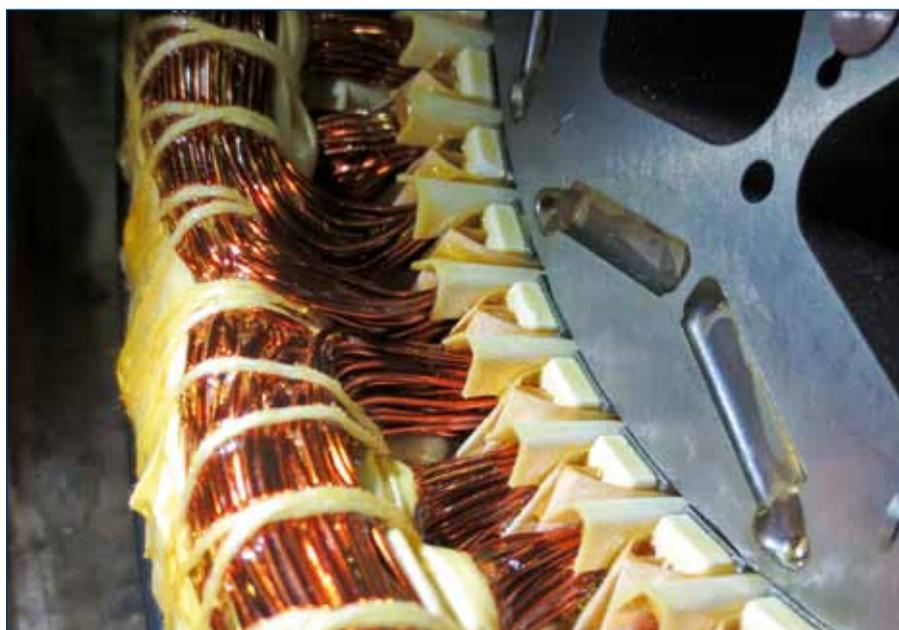
Wickelkopf einer E-Maschine.
