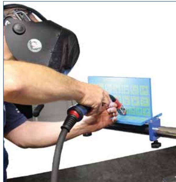
Mit einem virtuellen Simulator wird die Aus- und Weiterbildung von Schweißern am Volkswagen Bildungsinstitut bereits digital unterstützt.
