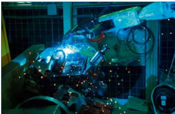
Komponenten für Karosserie und Abgassystem werden bei PCM.de umgeformt und verschweißt.
