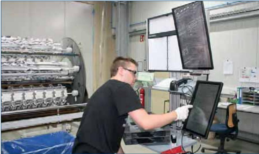
Statt mit Papier und Stift werden bei ZEIBINA Abweichungen im Metallisierungsprozess jetzt digital erfasst. Damit kann schneller auf Prozessfehler reagiert werden.
