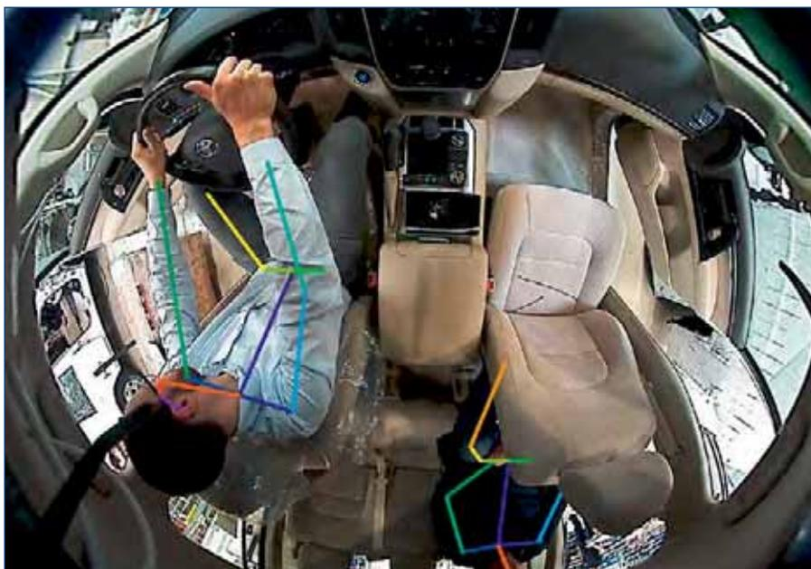
Erfassung der Körperhaltung von Passagieren im Fahrzeuginnenraum von Sonderfahrzeugen mit Technologie von 3dvisionlabs.
