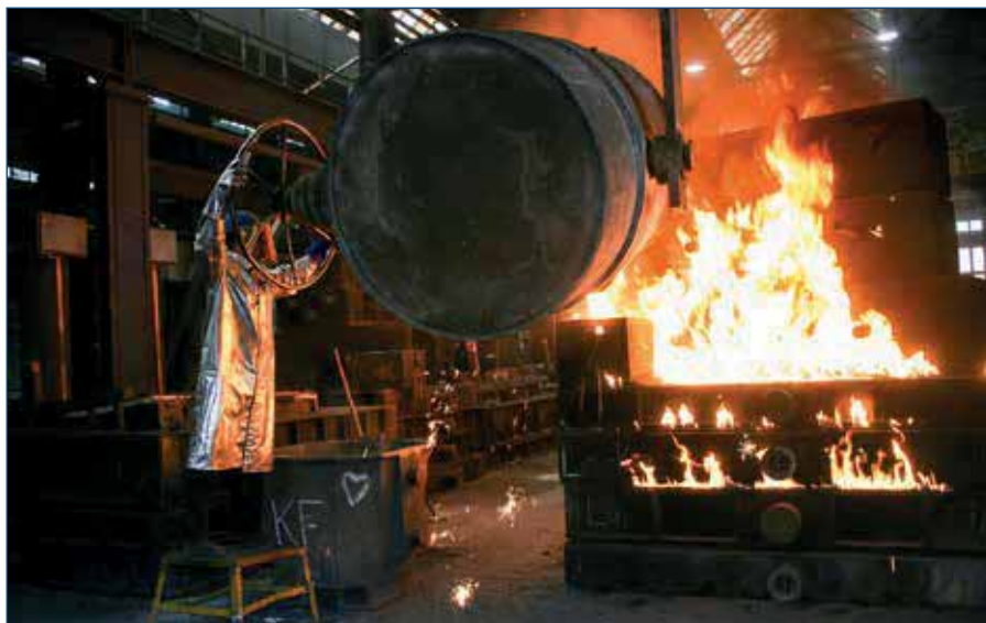
Abguss in der Gießerei Löbnitz. Unter den Flammen entstehen die Formen für automobile Großwerkzeuge, mit denen Karosserieteile gefertigt werden.
