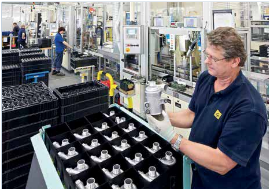
Fertigungslinie für Kühlmittelpumpen im Pierburg-Werk Hartha.
