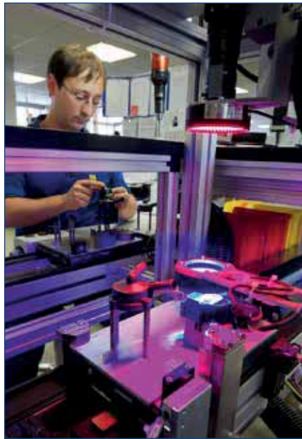
Optische Prüfung von Wassermwälzpumpen im Pierburg-Werk Hartha.
