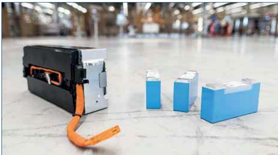
Im BMW-Werk Leipzig werden ab diesem Jahr Module für Hochvolt-Batterien gefertigt. Das Foto zeigt Batteriezellen und Batteriemodule auf der zukünftigen Produktionsfläche für die Module.
