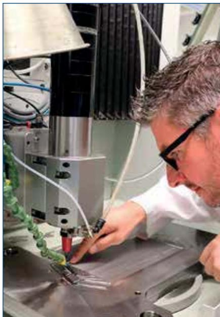
Vorbereitung des Werkzeugs für den Einsatz bei der Bipolarplatten-Fertigung.
