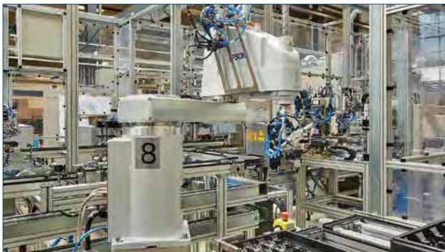
Auf dieser vollautomatischen Produktionslinie von Sitec wird intelligente Batteriesensorik gefertigt.
