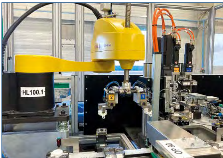
Anlage zur Produktion von Sitzbelegungssensoren bei Scherdel in Marienberg.
